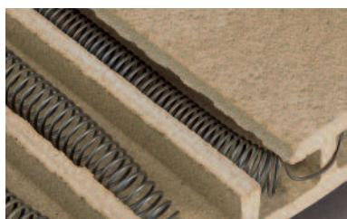
resistenze inserite nel refrattario per un maggior volano termico
