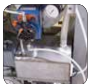
Réservoir d'huile avec remplissage par l'extérieur et alerte niveau bas
