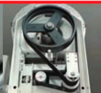
Réduction mécanique par poulies et courroies
