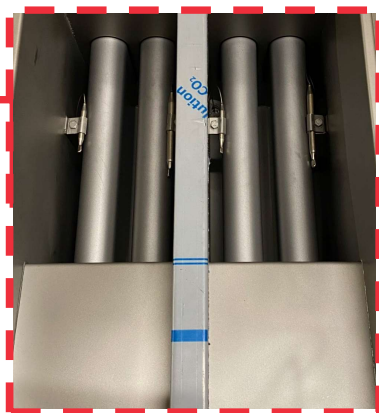
Fig.2 : Vue sur la double cuve et les éléments tubulaires
