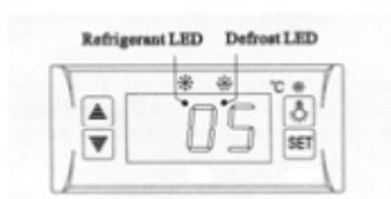
C'est un contrôleur intelligent intégré et applicable au compresseur Hp.
