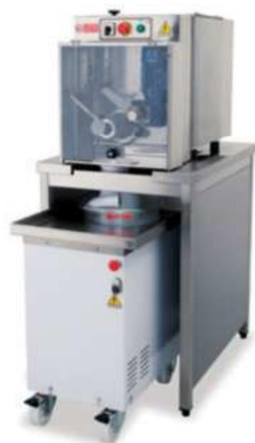
**ES** Son máquinas que sirven para redondear automáticamente porciones de hasta 300 y 800 g respectivamente.
