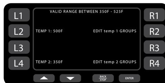
Figure 18 : Écran de modification des températures
